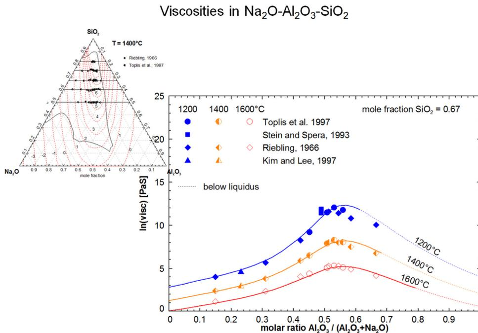
**Fig. 19.** Viscosity module – viscosities in  $\text{Na}_2\text{O}-\text{Al}_2\text{O}_3-\text{SiO}_2$ .
